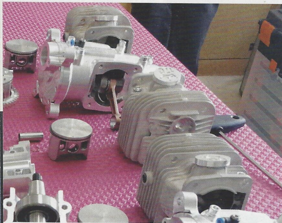
Kolben und Zylinder stammen von Mahle.
