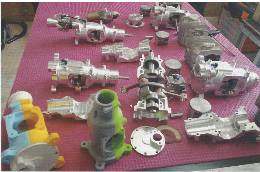
Einige Bauteile und Baugruppen der Boxer – vorn links im 3D-Druck erstellte Gehäuseteile.
